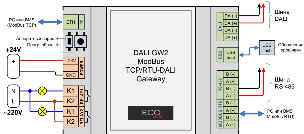
**24V.** Клеммы подключения питания устройства (24 V DC).
