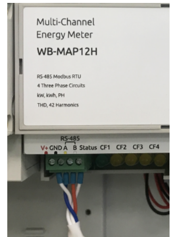
Подключение низковольтного питания и шины RS-485 к счетчику
