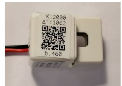
Пример наклейки с параметрами. Коэффициент трансформации - 2000. фазовый сдвиг - 1062
