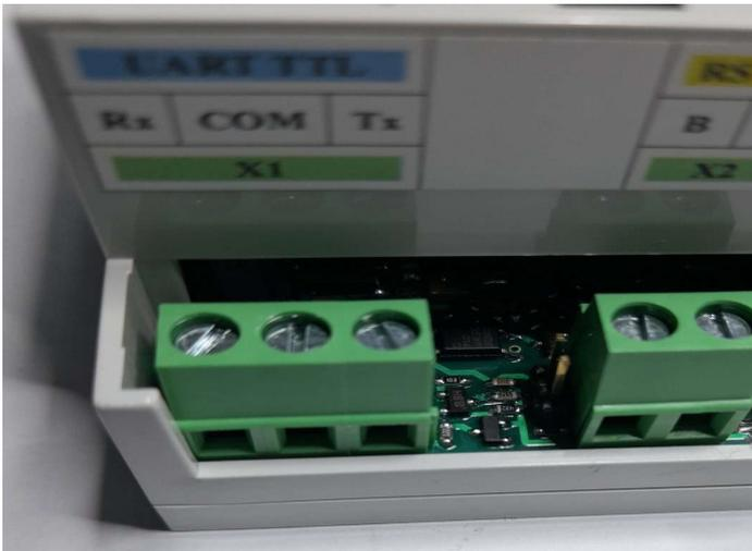
В случае неустойчивого обмена данными через интерфейс RS 485 может потребоваться подключить терминатор на шину данных.
