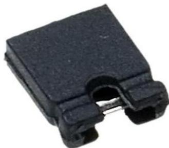
Приобрести перемычку (джампер 2x5мм 2 контактный закрытый, например - MJ2-C-5),
